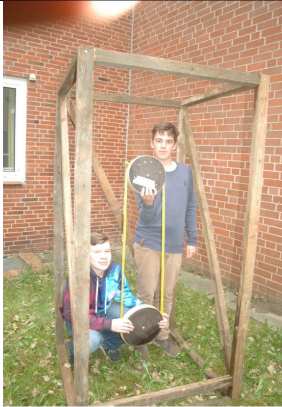
Abb. 2: Die beiden Riemenscheiben im 1m x 1m x2m – Kasten. Der Riemen ist noch zu kurz, die Befestigung fehlt noch und auch das Schöpfrad ist noch nicht montiert.
